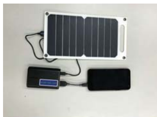
図4 ソーラーパネルとモバイルバッテリーによる給電
