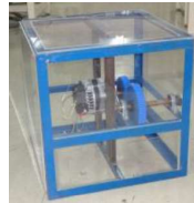
増速・発電ユニット
