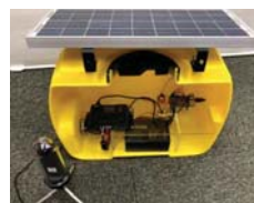
図9 水温センサ付き監視フロート
