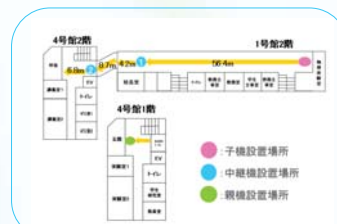
図6 ネットワーク構築概要図
