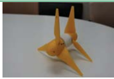
3Dプリンタで製作した二重反転水車
