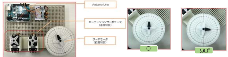
サーボモータ制御装置の外観
