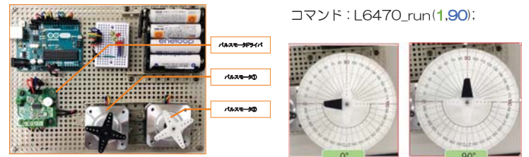
パルスモータ制御装置の外観
