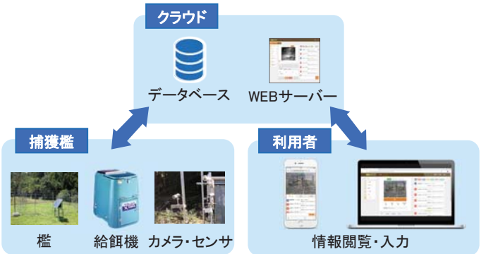
図3 システムの概要図
